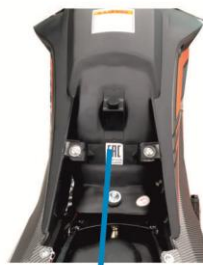
Табличка с Единым знаком обращения на рынке и номером «Одобрения типа транспортного средства»
