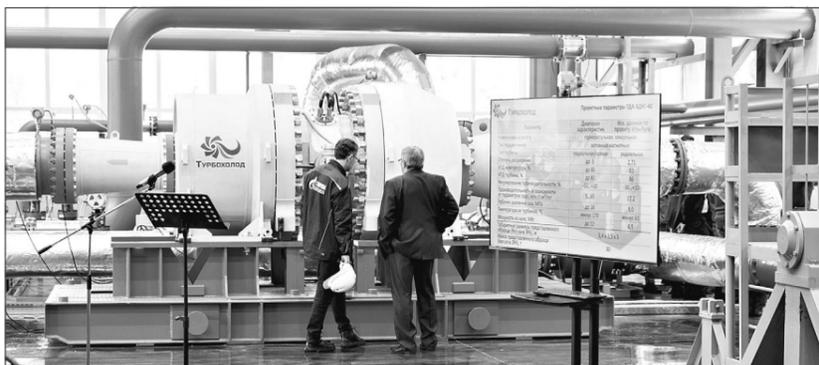
28 октября на заводе имени В.А. Дегтярёва состоялись итоговые **приемосдаточные газодинамические испытания турбодетандерного агрегата АДКГ-40** производительностью до 40 млн ст. м<sup>3</sup>/сутки в соответствии со стандартами ИНТИ.
