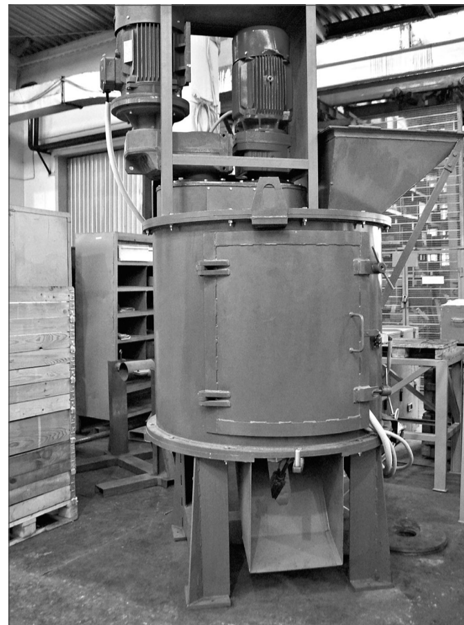
Смеситель для приготовления формочной смеси.
