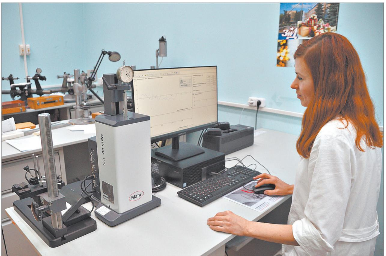
**Измерения на приборе для поверки измерительных головок и датчиков проводит контролер ЦИЛ М. М. Коновалова.**
