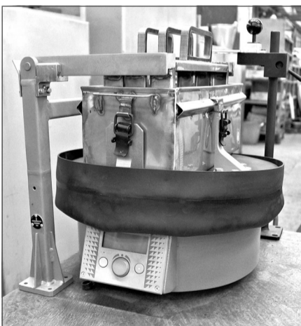
Установка вибрационной мойки.
