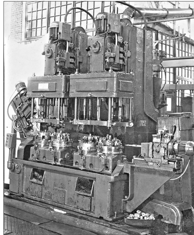
Агрегатный сверлильно-расточной 23-шпиндельный инструментальный станок.
