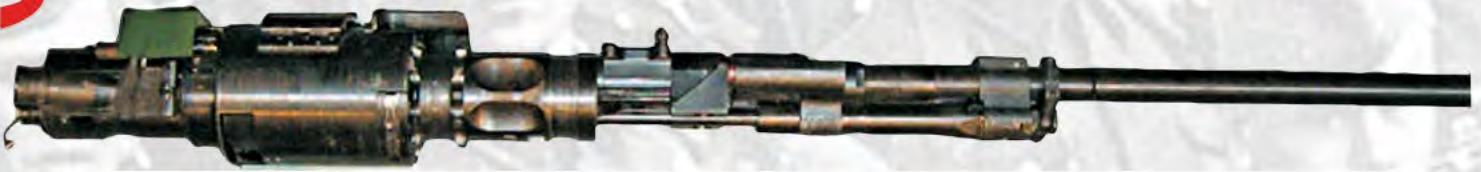
20-мм авиационная автоматическая пушка ШВАК (Шпитального-Владимирова).
