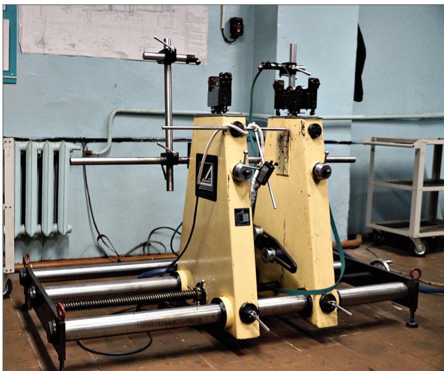
О. Зубков у станка для динамической балансировки.
