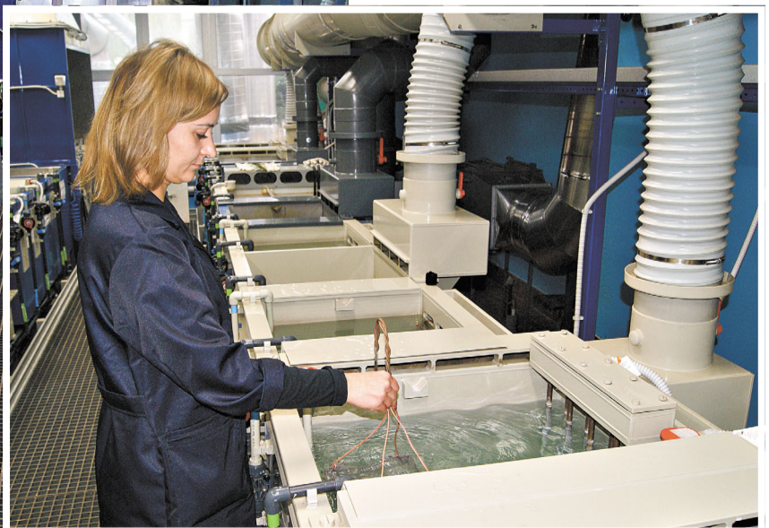
Линия пассивации. Гальваник М. Халилова.
